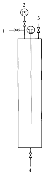
Abb. 1 Laborreaktor zur Spaltung von Chlormethylidisilanen mit Chlorwasserstoff
